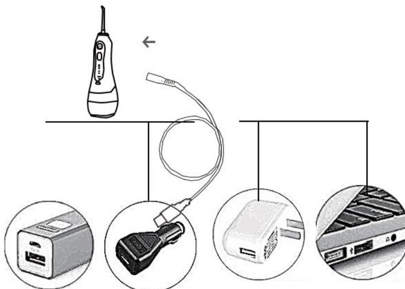
Este produto não vem com carregador AC / DC. A unidade é carregada por meio de dispositivos com recursos de alimentação USB de 5 V, como telefone celular, laptop, carregador de parede com alimentação USB, etc. O indicador de carga do aparelho piscará durante o carregamento e permanecerá ligado continuamente quando estiver totalmente carregado. Uma recarga completa levará de 3 a 5 horas.
